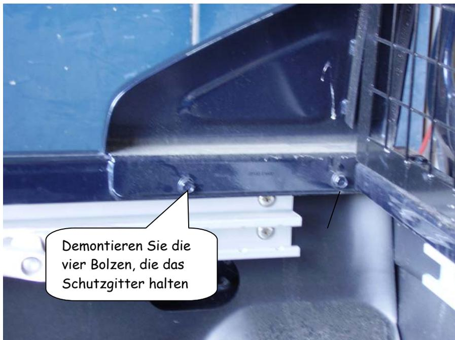
Demontieren Sie die vier Bolzen, die das Schutzgitter halten
