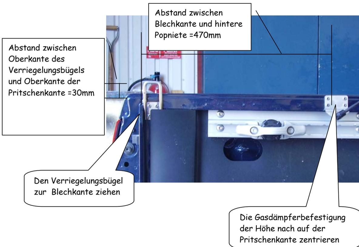
Legen Sie den Pritschendeckel auf das Schutzgitter und schrauben Sie die Scharniere am Vorderteil fest
