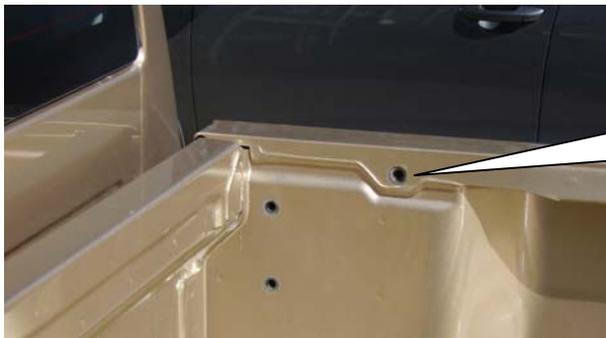
Schrauben Sie ebenfalls die hintere der drei Schrauben an der vorderen Pritschenkante ab.
