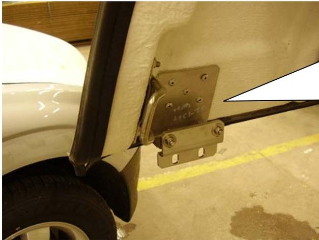
Schrauben Sie die Emballagebretter auf der Haube ab und lösen Sie die Muttern an den einstellbaren Befestigungsbeschlägen so das die verschiebbar sind, wenn die Haube auf ihren Platz gestellt wird. Applizieren Sie auch die Dichtungsleiste an der Unterseite der Beschläge um Kratzer an der Pritschenkante zu vermeiden. Danach wird die Haube auf ihren Platz auf das Fahrzeug gehoben.
