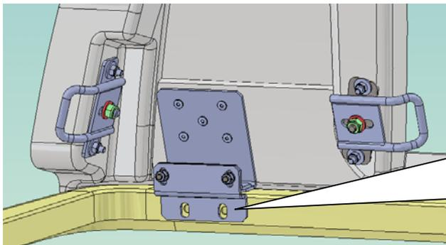
Beginnen Sie damit die hinteren Beschläge zu fixieren indem Sie die Haube nach vorne und gleichzeitig nach innen schieben, und die Beschläge gleichzeitig anziehen. Fixieren Sie danach die vorderen Beschläge.
