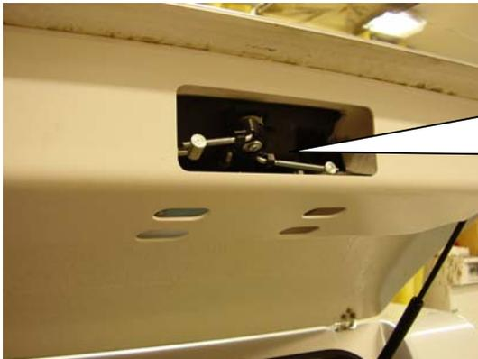
Am Mittelschloss gibt es die Möglichkeit die Länge der Verriegelungsstangen zu ändern indem man den Kunststoffclip löst und die Verriegelungsstange dreht. Diese hat in der Verbindung zum Verriegelungshaken ein Gewinde.
