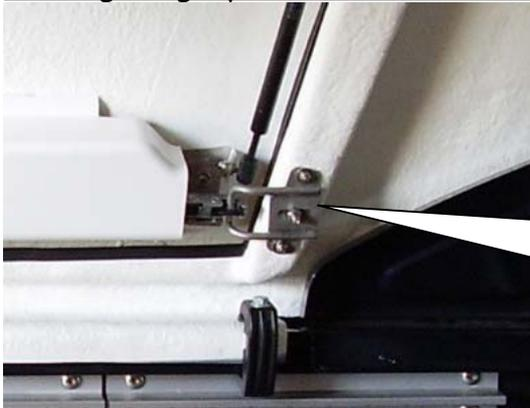
Kontrollieren Sie, dass die Klappen leicht zu schließen und zu öffnen sind und die Schlösser richtig eingestellt sind. Bei Bedarf das Schloss oder den Verriegelungsbügel nachstellen.
