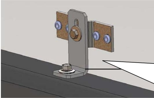
Montieren Sie die vorderen Befestigungen laut Abb. Platzieren Sie die Befestigung nach unten zur Pritschenkante und schrauben Sie diese im befindlichen Beschlag in der Haube fest. Mit Hilfe der vorderen Befestigung den vorderen Teil nach hinten ziehen und gleichzeitig auf der Pritschenkante markieren wo die Löcher für die selbstschneidenden Schrauben zu bohren sind. Bohren Sie 4,9-5,0 mm Löcher in den Pritschenkante und ziehen Sie die Schrauben fest.
