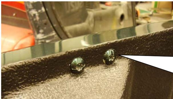
Schrauben Sie die hinteren Schrauben an der Innenseite der Pritschenkante ab. Wenn notwendig, können diese gegen M8 Schrauben, die im Montagesatz enthalten sind, ausgetauscht werden. Applizieren Sie den Schutzklebestreifen auf der Oberseite der Pritschenkante um Kratzer zu vermeiden.
