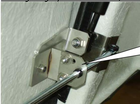
Kontrollieren Sie, dass die Klappen leicht zu schließen sind und die Schlösser richtig eingestellt sind. Bei Bedarf den Gleitwinkel der Höhe nach verändern.
