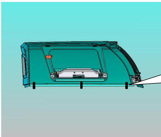
Drücken Sie die Haube seitwärts nach beiden Seiten und befestigen Sie die Klammern wie auf dem Bild. Die Haube auf der Pritschenkante mit den Klammern festziehen mit **Max. 10Nm.**
