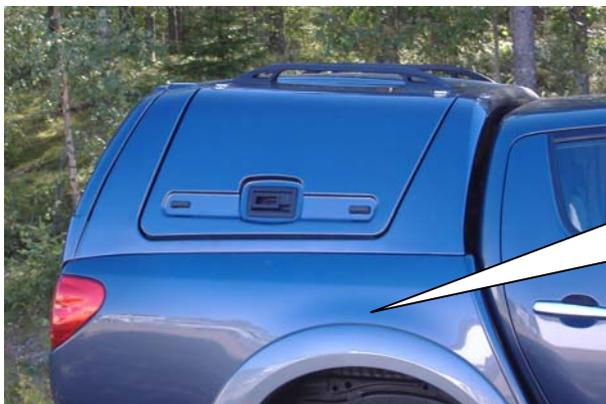
Heben Sie die Haube vorsichtig auf das Auto und schieben diese so nach vorne, dass das Vorderteil der Pritsche hierdurch gut abgedichtet wird
