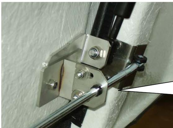
Kontrollieren Sie auch, dass die Klappen leicht zu öffnen und zu schließen sind, und dass die Schlösser korrekt eingestellt sind. Bei Bedarf ist die Höhe des Gleitwinkels zu ändern.
