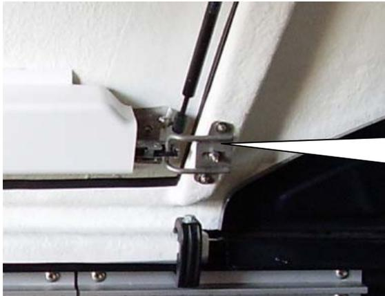
Kontrollieren Sie, dass die Türen leicht zu schließen sind und dass die Schlösser richtig eingestellt sind. Bei Bedarf das Schloss und Schlossbügel nachstellen.
