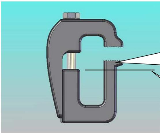
Falls das Auto mit einer so genannten C-Schiene ausgerüstet ist müssen die beiden mittleren Klammern modifiziert werden damit diese zwischen C-Schiene und Pritschenkante Platz haben. Den markierten Teil des Unterteils der Klammer in Höhe mit der Linie absägen.
