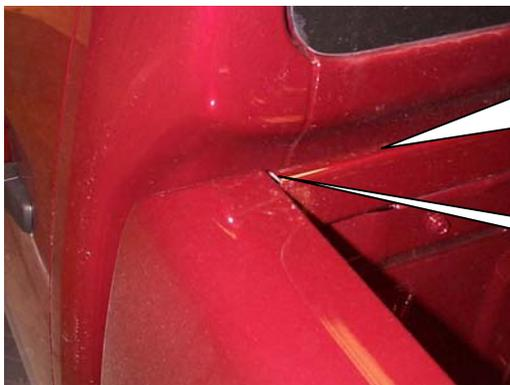
Applizieren Sie die Gummileiste an der Oberkante vom Vorderteil der Pritsche so dass diese den Abstand von der Blechkante „A“ zum entsprechenden Punkt auf der anderen Seite deckt.
