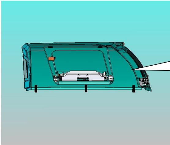
Drücken Sie die Haube seitwärts nach beiden Seiten und befestigen Sie die Klammern wie auf dem Bild. Siehe die Anweisung beim nächsten Bild. Die Haube auf der Pritschenkante mit den Klammern festziehen.
