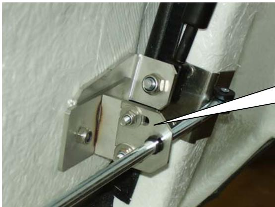
Kontrollieren Sie, ob die Klappen leicht schließt. Wenn nicht, kann die Stangenriegelbefestigung in der Höhe verstellt werden, so dass die Klappe parallel anliegt.
