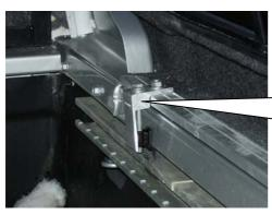
Befestigen Sie die Haube an der Pritschenkante mit den Befestigungsbeschlägen laut Abb. Bei einigen Modellen ist es vielleicht notwendig die Pritschenverkleidung einzukerben damit die Beschläge unter die Pritschenkante greifen können.
