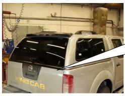
Schliessen Sie die hintere Pritscheklappe und applizieren Sie den Schutzklebestreifen dort, wo die Gummileiste der Haubenklappe anliegt um die Lackierung zu schützen.
