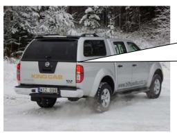
Stellen Sie die Haube auf ihren Platz und ziehen Sie diese zurück, sodass die Rückseite des Führerhauses nicht verschrammt wird und außerdem so an der hinteren Kante platziert ist, dass die Haubenklappe die Pritschenkante abdichtet. Die Klappe muss gleichzeitig in einer Linie mit der Haube sein.
