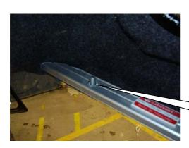
Wenn das Fahrzeug mit Schienen auf dem Dach und Gitter ausgerüstet ist, müssen die Schienen während der Montage entfernt werden, bevor die Haube angepasst werden kann. Nachder Montage der Haube wieder befestigen. Fangen Sie danach an die Wagenbolzen in der Haubenrippe und die Transporthölzer an der Unterseite der Haubenrippe zu entfernen.
