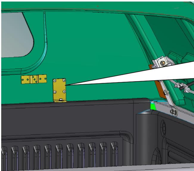
Plazieren Sie zwei Winkelbleche an der Stirnwand, bohren und dann Festnieten. Danach bohren Sie mit Bohrer 4,9-5,0 mm Löcher für die selbstschneidenden Schrauben in die Pritschenwand und danach die Winkelbleche festschrauben.
