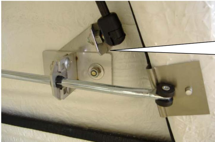
Kontrollieren Sie ob die Klappen leicht zu schließen und die Schlösser richtig eingestellt sind. Bei Bedarf ist die Höhe des Gleitwinkels zu ändern.
