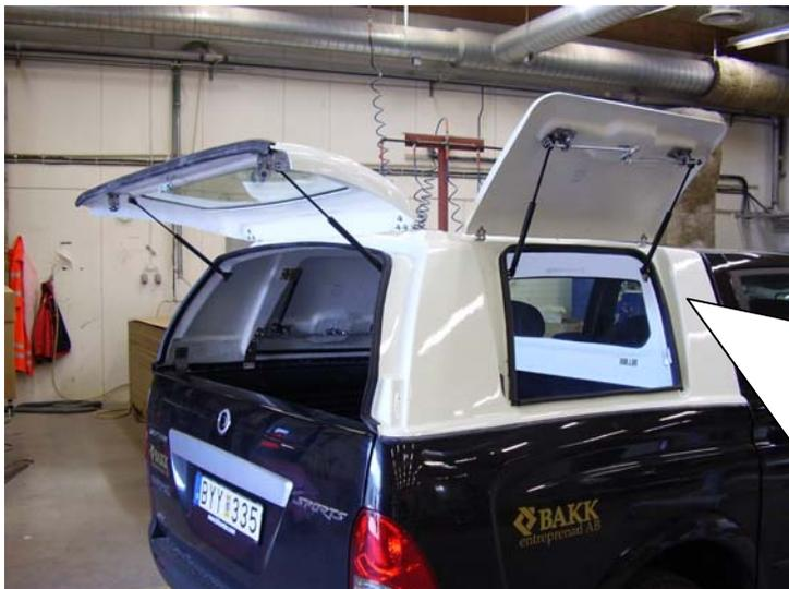
Heben Sie die Haube vorsichtig auf das Fahrzeug und ziehen Sie diese nach hinten bis die untere Kante der Stirnwand an der Stirnwand des Fahrzeugs anliegt. **Achtung!** Kontrollieren Sie dass die beiden hinteren Leitbleche an der Innenseite der Haube nicht am Fahrzeug scheuern, wenn die Haube gesenkt wird. Kontrollieren Sie dass genügend Platz zwischen Haube und Kabine vorhanden ist sodass die Haube nicht am Fahrzeug scheuert.
