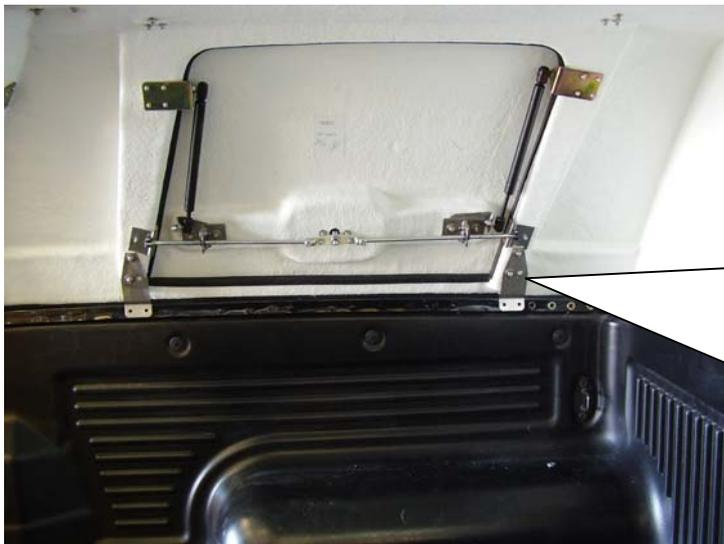
Bevor Sie die Haube auf das Fahrzeug heben, applizieren Sie die selbstklebende Zellgummileiste an der Unterseite der Haubenflansche und lösen Sie die 4 Befestigungsbeschläge, die mit M6-muttern befestigt sind, damit diese nicht an der Pritschenkante scheuern, wenn die Haube auf ihren Platz gestellt wird.
