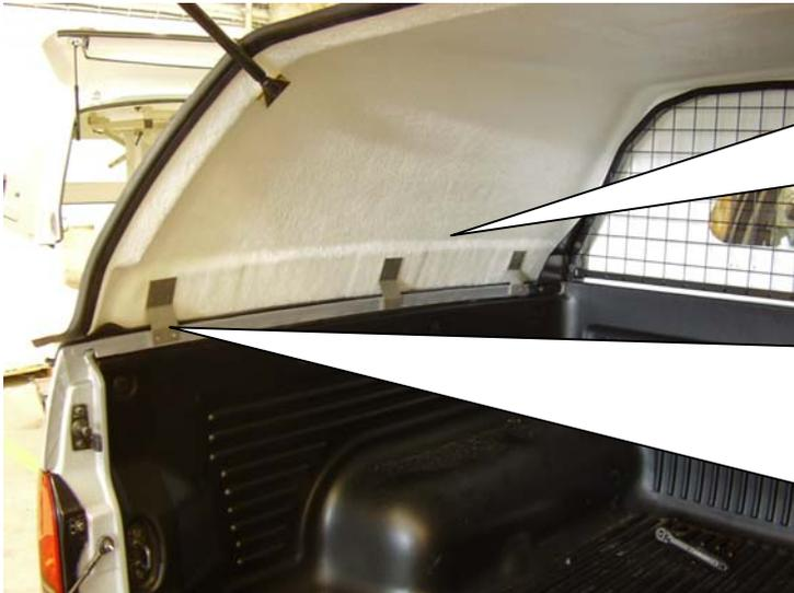
Bevor Sie die Haube auf das Fahrzeug heben, applizieren Sie die selbstklebende Zellgummileiste an der Unterseite der Haubenflansche.
