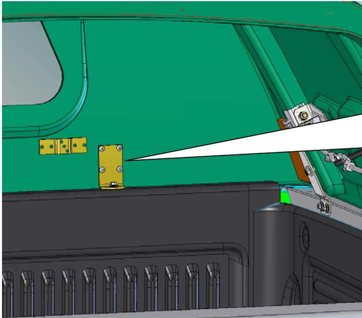
Plazieren Sie zwei Winkelbleche an der Stirnwand, bohren und dann Festnieten. Danach bohren Sie mit Bohrer 4,9-5,0 mm Löcher für die selbstschneidenden Schrauben in die Pritschenwand und danach die Winkelbleche festschrauben.
