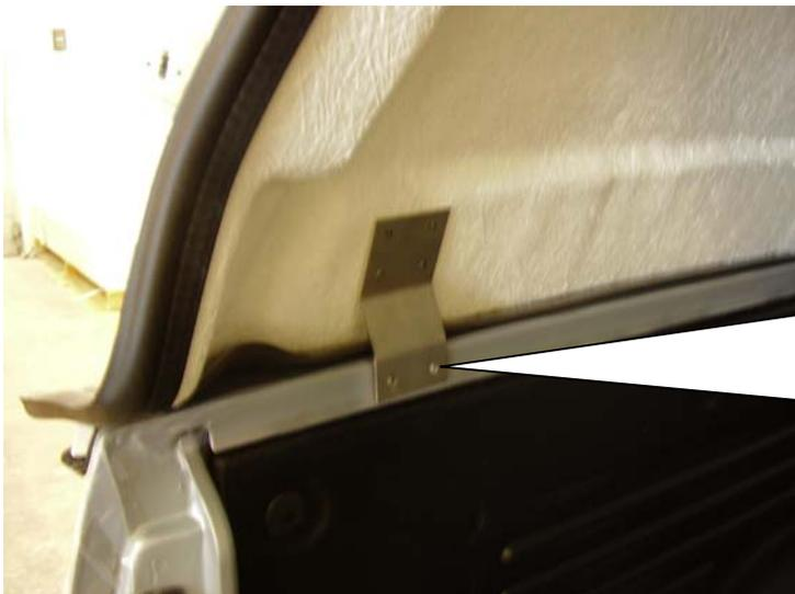
Heben Sie die Haube vorsichtig auf das Fahrzeug, sodass die Befestigungsbleche an der Innseite der Haube nicht an der Pritschenkante scheuern. Ziehen Sie die Haube nach hinten bis die untere Kante der Stirnwand an der Stirnwand des Fahrzeugs anliegt. Kontrollieren Sie dass genügend Platz zwischen Haube und Kabine vorhanden ist sodass die Haube nicht am Fahrzeug scheuert.
