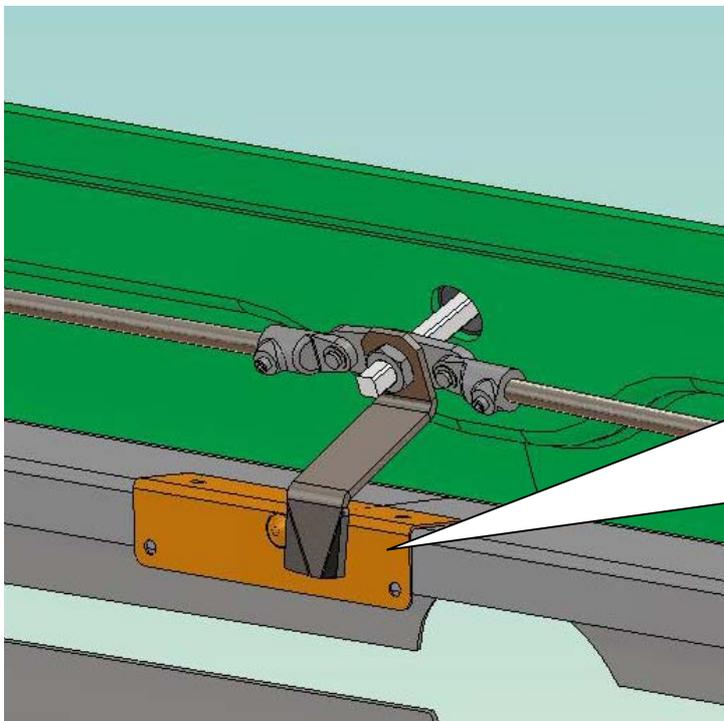
Schließen Sie die hintere Klappe und markieren Sie auf der Ladeflächenklappe, wo das Schlossblech platziert werden soll. Säubern Sie die Fläche (z.B. mit Spiritus) und fixieren Sie das Schlossblech indem Sie dieses ordentlich festdrücken.
