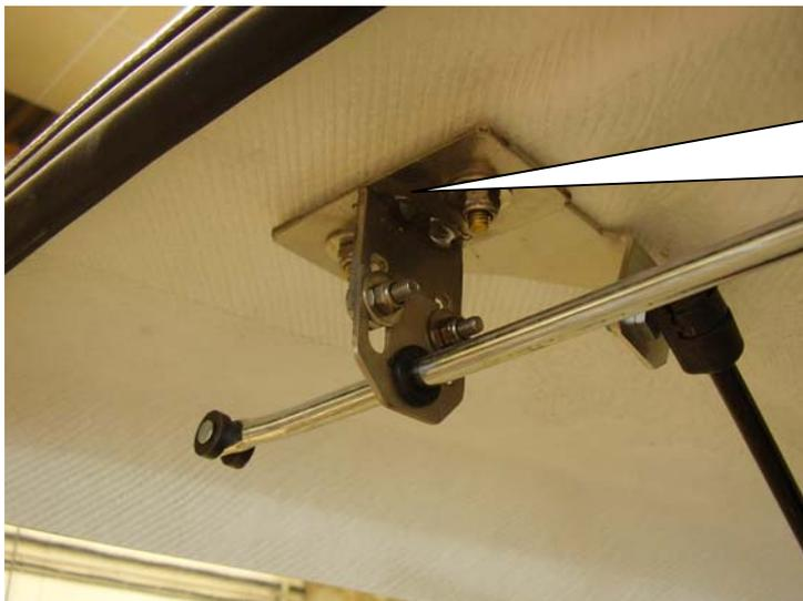
Kontrollieren Sie ob die Klappe leicht zu schließen ist und die Schösser richtig eingestellt sind. Bei Bedarf ist die Höhe des Gleitwinkels zu ändern.
