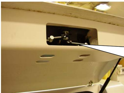
Am Mittelschloss gibt es die Möglichkeit die Länge der Verriegelungsstangen zu ändern indem man den Kunststoffclips löst und die Verriegelungsstange dreht. Diese hat in der Verbindung zum Verriegelungshaken ein Gewinde.
