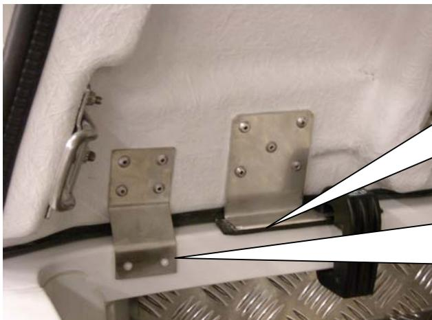
Bevor die Haube auf ihren Platz auf das Fahrzeug gestellt wird, die Zellgummileiste an der Unterseite der Befestigungsbeschläge anbringen um Kratzer an der Pritschenkante zu vermeiden.
