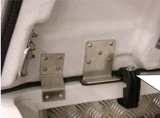
Die Haube so nach hinten ziehen, dass sie mit der Vorderkante nicht an der Kabine scheuert. Die hinteren Klammern laut Abb. auf den Befestigungsbeschlägen anbringen, indem Sie die Haube von der Außenseite zur Pritschenkante schieben, und die Klammern gleichzeitig festziehen. **Beachten Sie! Anziehungsmoment maximal 10 Nm**
