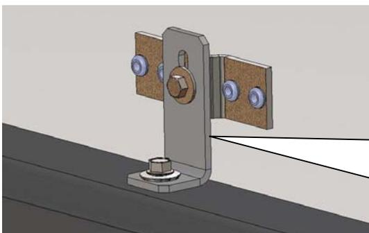
Montieren Sie die vorderen Befestigungen laut Abb. Platzieren Sie die Befestigung nach unten zur Pritschenkante und schrauben Sie diese im befindlichen Beschlag in der Haube fest.
