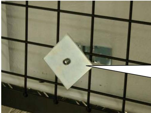
Montieren Sie die Befestigungen laut Abb. Die Stiftschrauben mit Mutter mit der Hand in den Metallbeschlag auf der Haube schrauben. Die Schrauben dann so gut wie möglich festziehen. Danach die große Vierkantscheibe und Gegenmutter montieren und festziehen.
