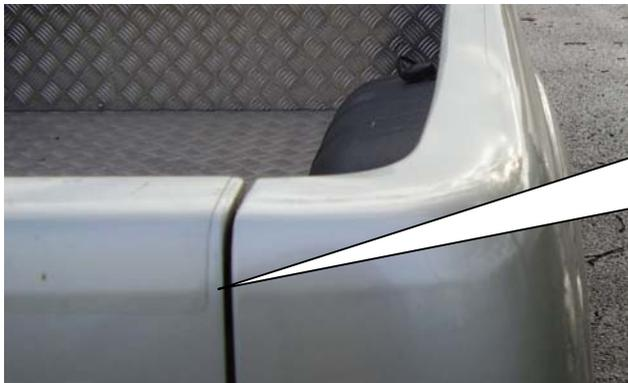
Zuerst die Pritschenkante säubern und den transparenten Schutzklebestreifen an der Pritschenkante anbringen, genau wie den Schutzklebestreifen an der hinteren Klappe.
