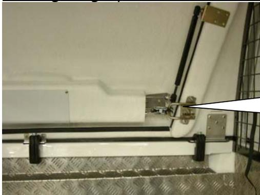
Kontrollieren Sie, dass die Klappen leicht zu schließen und zu öffnen sind und die Schlösser richtig eingestellt sind. Bei Bedarf das Schloss oder den Verriegelungsbügel nachstellen.
