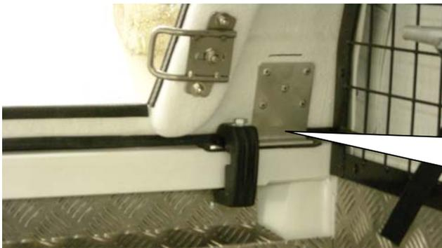
Machen Sie das Gleiche mit den Klammern auf den vorderen Befestigungsbeschlägen. **Beachten Sie! Anziehungsmoment maximal 10 Nm**
